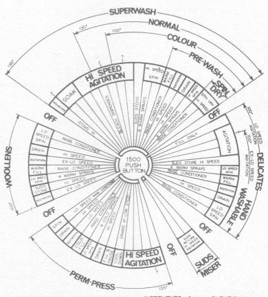
INCREMENTS 2 min. DURATION NOTE T DENOTES POSITION IN CYCLE WHERE MACHINE COMES UNDER THE CONTROL OF THE THERMOSTAT
